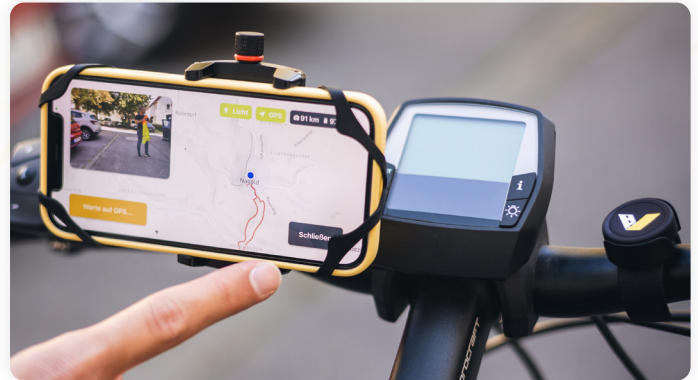
Das vialytics System ermöglicht dank Smartphone und Lenkerknopf die digitale Streckenkontrolle zu Fuß, im Auto oder auf dem Fahrrad.
